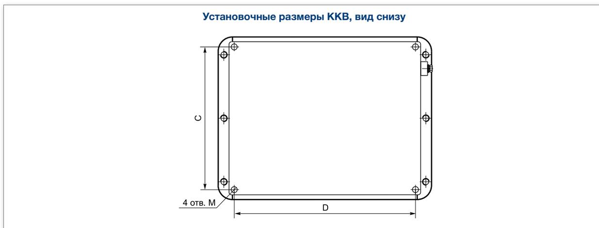
Таблица 6. Установочные размеры взрывозащищенных клеммных коробок ККВ
