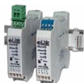
Предназначен для преобразования сопротивления стандартных термопреобразователей сопротивления или термодпар, расположенных во взрывоопасных зонах, в унифицированный сигнал тока 4–20 мА и цифровой сигнал с гальваническим разделением входных и выходных цепей . . . . . **стр. 38**
