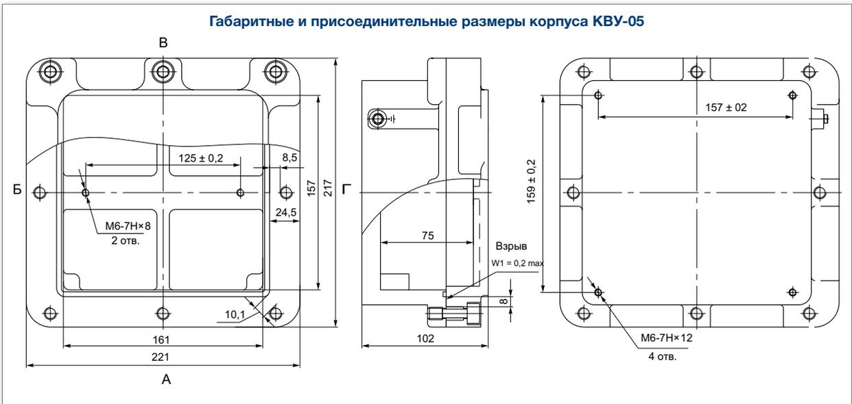
Габаритные и присоединительные размеры корпусов КВУ-05-01
