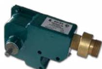
Конечный выключатель для коммутации электрических цепей при повороте оси выключателя по часовой стрелке или против часовой стрелки до достижения подвижной частью оборудования конечных положений. Имеется возможность регулировки точек срабатывания при повороте оси в одну и другую сторону в пределах от 0° до 30° ..... **стр. 67**
