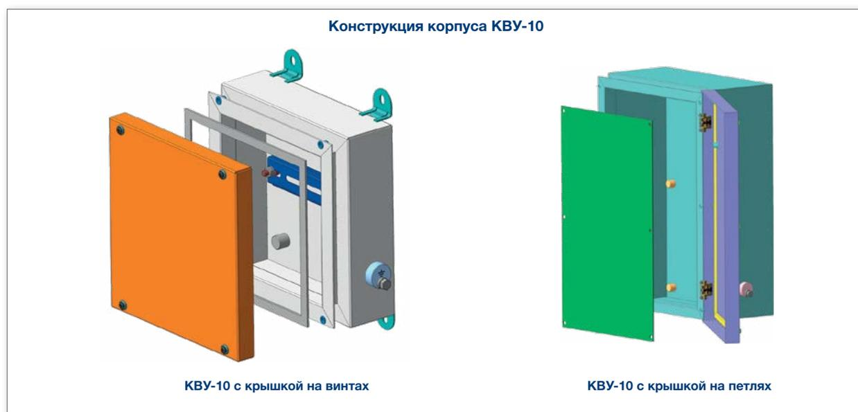
Внутри корпуса может быть установлена монтажная панель, которая крепится винтами в резьбовые втулки, герметично вваренные в дно корпуса. Эти же втулки используются для крепления монтажных кронштейнов. Монтажный кронштейн может быть установлен так, как показано на рисунке, и может быть повернут на 90°.
