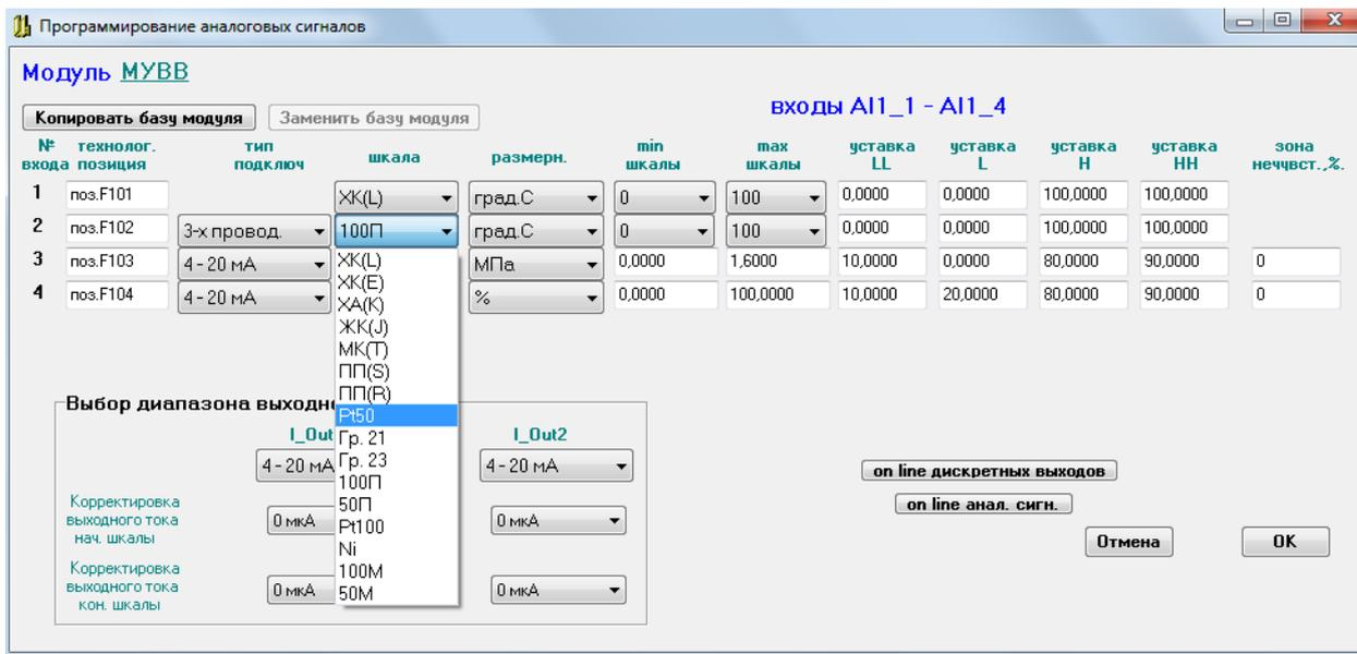
В зависимости от типа первичного термопреобразователя для входов №1 и №2 допустимыми являются следующие фиксированные значения начала и конца шкалы (выбираются из списков «min шкалы» «max шкалы»):
