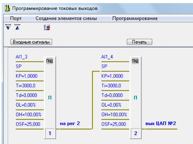
В режиме ON\_LINE каскадная схема отображается в виде 2-х регуляторов: регулятор №1 – регулятор внешнего контура, регулятор №2 – регулятор внутреннего контура.
