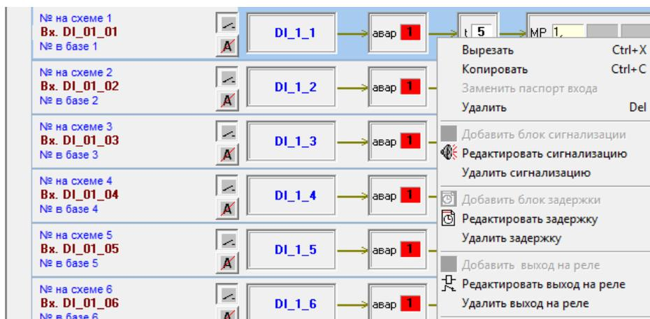
Задать релейные выходы, которые должны срабатывать по выбранному дискретному сигналу. В приборе может быть только один модуль реле на 8 выходов, задавать можно любое количество выходов из 8..
