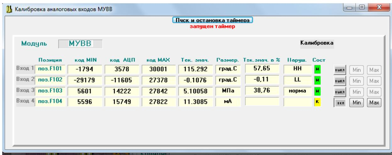
Для калибровки необходимо подключить к калибруемому входу источник входного сигнала и образцовое средство измерения входного сигнала классом точности не ниже 0,05 % или подать входной сигнал от соответствующего калибратора.
