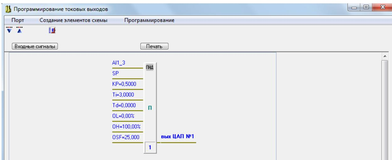
Для редактирования контура регулирования нужно активизировать панель контура щелчком левой кнопки мыши по любому полю этой панели, (при этом панель меняет цвет и становится голубой). Щелчок по другой панели «погасит» ранее активизированный контур.
