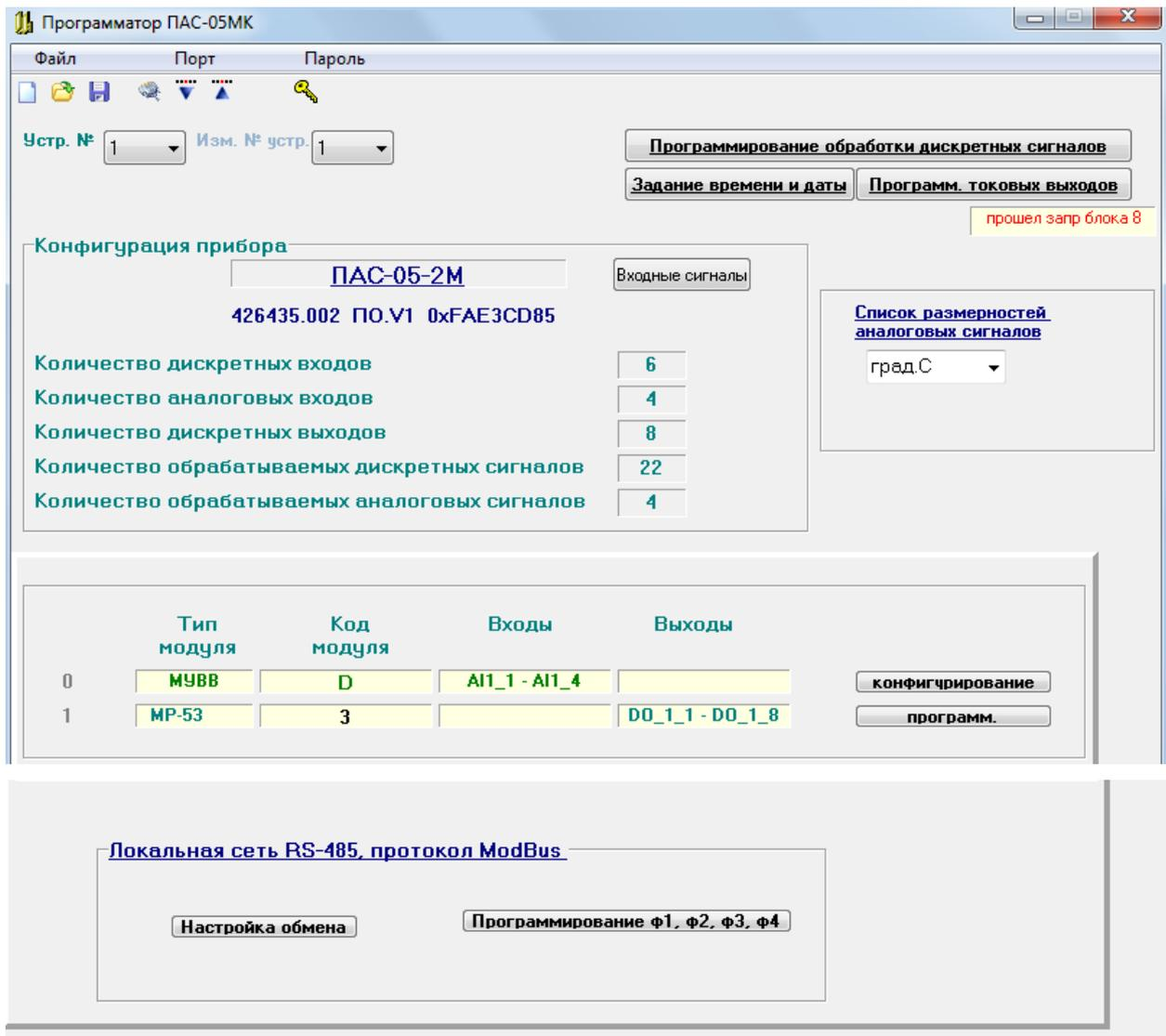
Исполнение ПАС-05-2М комплектуется программируемым модулем универсального ввода-вывода МУВВ - код модуля 0x0D. При нажатии на клавишу «КОНФИГУРИРОВАНИЕ» программатор разворачивает базу данных МУВВ в виде графической схемы.
