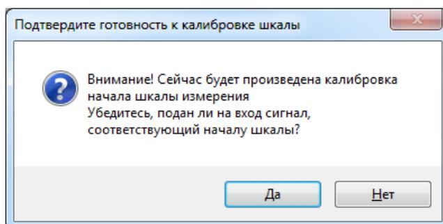
Нажать кнопку «Да», при этом команда калибровки MIN поступает в прибор. В модуле МУВВ значение входного сигнала, зафиксированное в данный момент в виде двоичного кода АЦП, запоминается в EEPROM модуля в качестве нижней реперной точки измерительного канала данного входа (код MIN).
