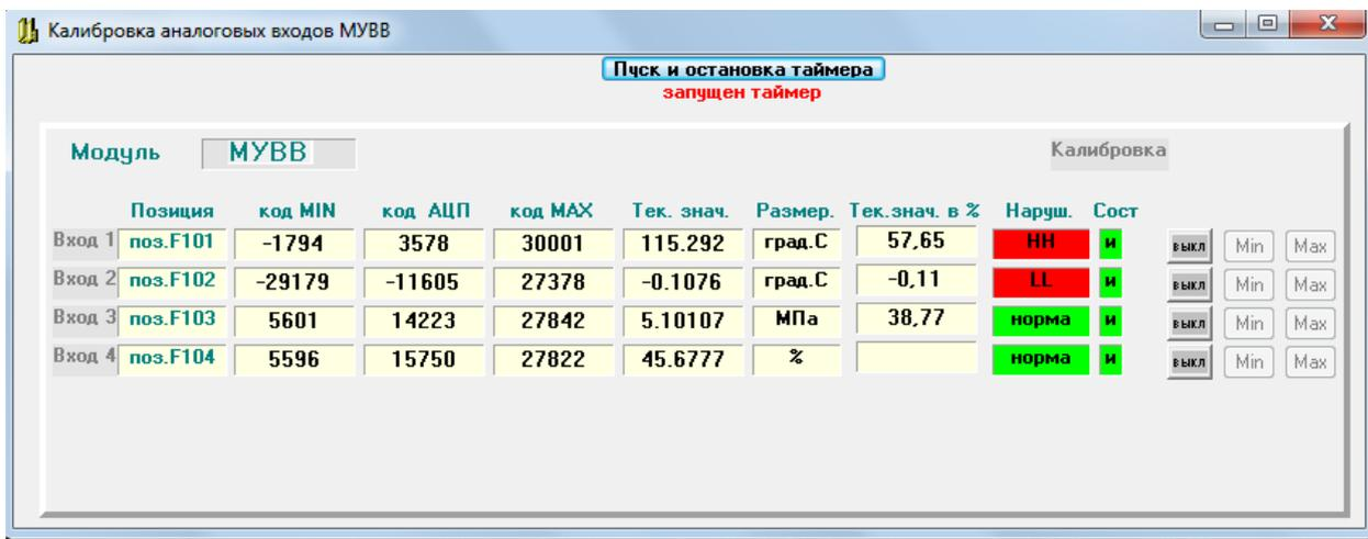
Модули МУВВ для входов №1 и №2 имеют заводскую калибровку начала и конца диапазона измерения, охватывающую все предусмотренные типы первичных термопреобразователей и диапазоны измерения температур.
